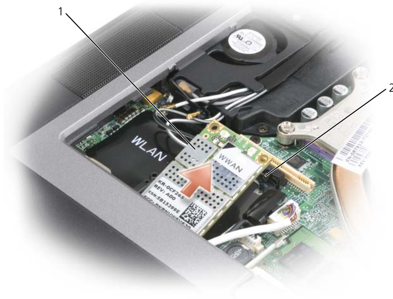
1 ワイヤレス WAN カード 2 金属製固定ブラケット (2)
